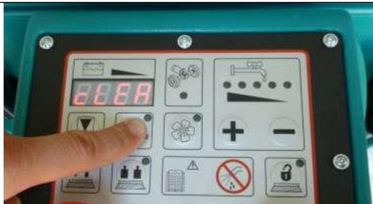
Con máquina apagada apretar en modo prolongado la tecla ECO-SYSTEM poner la llave en pos. 1. Tener apretada la tecla hasta cuando no aparece en la pantalla la escrita cLEA. En este momento colocarse en la zona del filtro ECO-SYSTEM.
