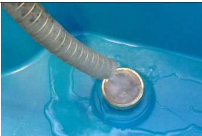
Cuando se escucha que comienza a fucionar la bomba echar el agua en el vasito que lleva el filtro para permitir la correcta limpieza de toda la instalación ECO-SYSTEM (tubería, electroválvula, bomba)
