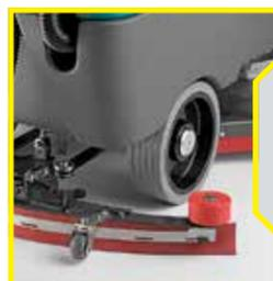
LA LIBERACIÓN AUTOMÁTICA DEL LIMPIAPAVIMENTOS evita daños a la máquina y al ambiente en caso de colisión accidental.
