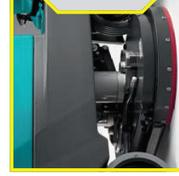
EL CABEZAL DE CEPILLOS cuenta con un protector de seguridad regulable que, además de evitar las salpicaduras de agua sucia durante el lavado del pavimento, permite evitar las pérdidas de agua.
